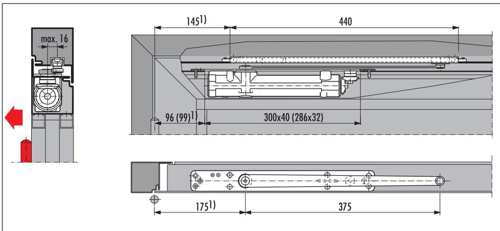
ITS 96 mit Gleitschiene G 96 N20 in einer **Holz**tür in **Kopfmontage**
