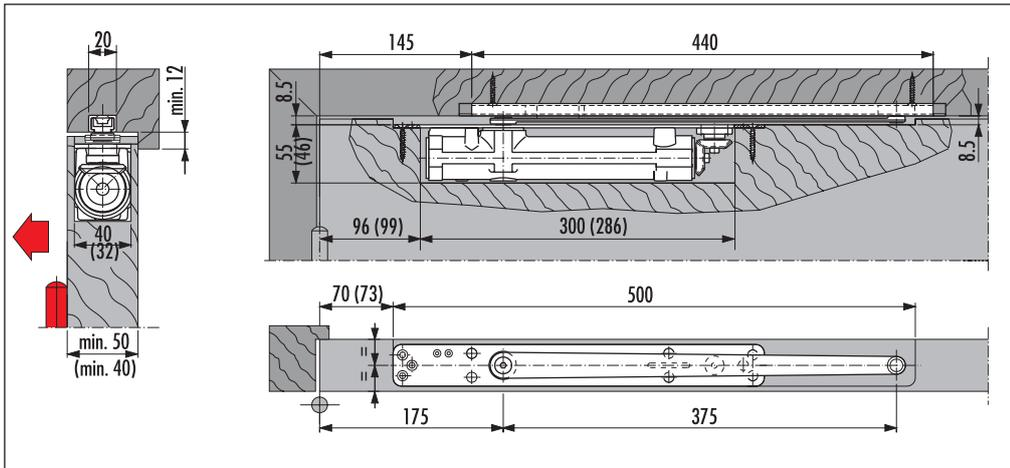
ITS 96 mit Gleitschiene G 96 N20 in einer **Profil**tür
