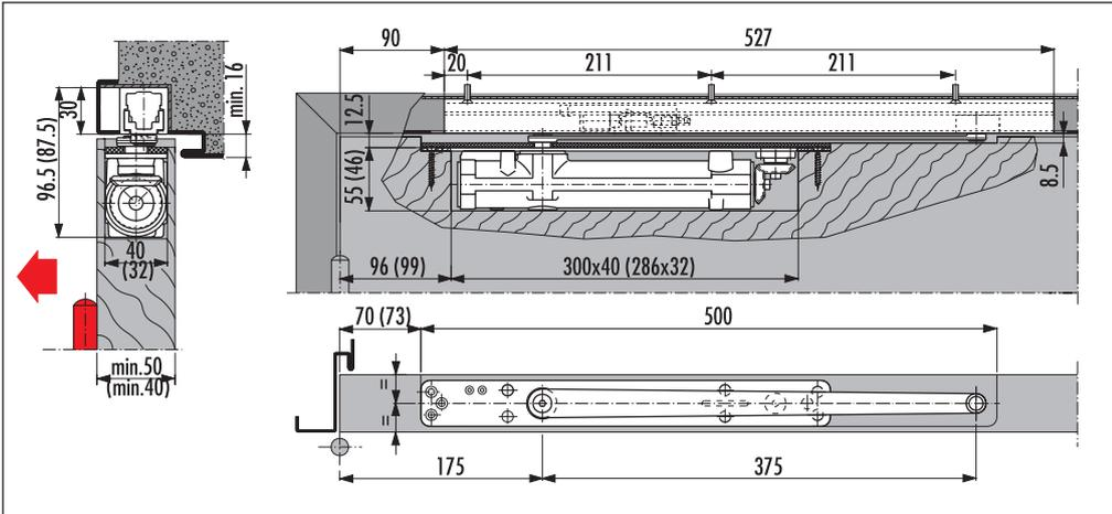
ITS 96 mit Gleitschiene G 96 EMF in einer **Profil**tür
